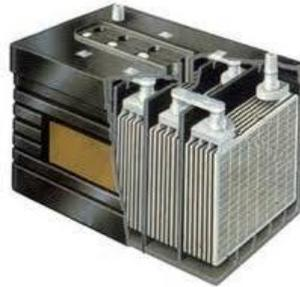
La capacidad en amperios-hora está determinada principalmente por la cantidad de óxido de plomo contenido en el ánodo y que puede fácilmente combinarse con el ácido sulfúrico para producir sulfato de plomo. En el cátodo existe la misma cantidad aproximadamente de plomo que en el ánodo pero presenta una eficiencia superior durante las reacciones de carga y descarga por lo que las limitaciones están originadas por el electrodo positivo.
