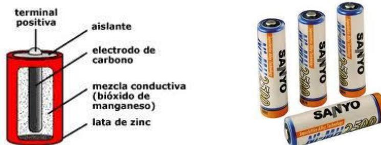
La envoltura externa de la cápsula es de cinc, cerrándose herméticamente el conjunto por la zona superior, asomándose únicamente el terminal de positivo en contacto con la barra de carbón. Sobre la caja metálica externa se encuentra una cubierta aislante, quedando al descubierto la base inferior para realizar la conexión.
